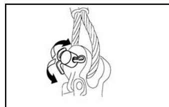
Installation av krok
