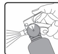
3. SQUEEZE HANDLES TOGETHER AND SWEEP THE EXTINGUISHER STREAM SIDE TO SIDE
