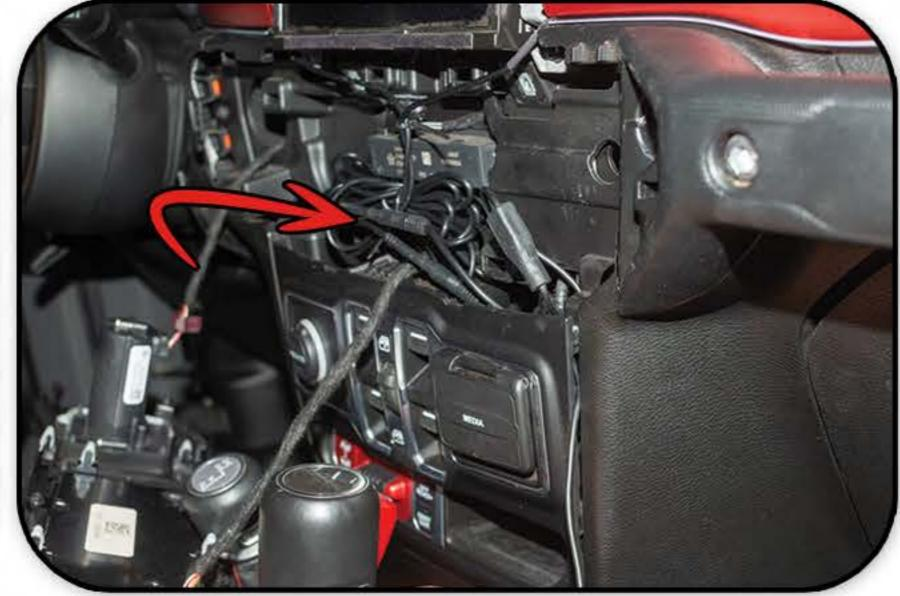
ALL THE STRIP POWER WIRES WILL TUCK BEHIND THE CLIMATE CONTROL MODULE.
