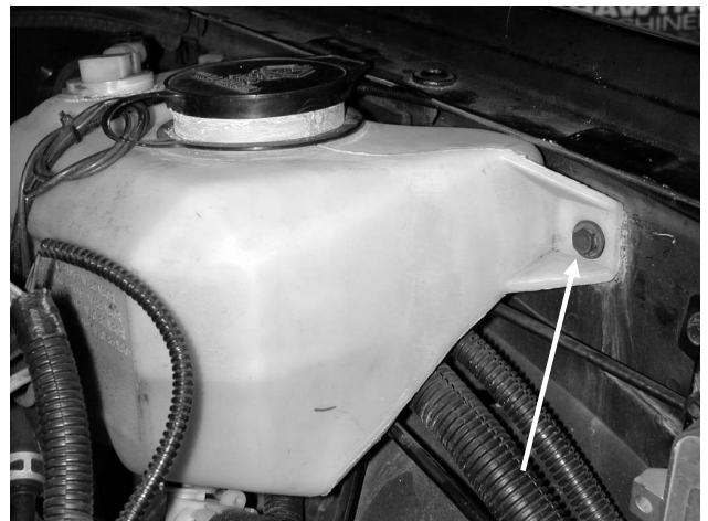
e) Remove washer bottle bolt.
