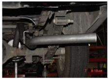
INSTALL EXITPIPE #D ONTO
