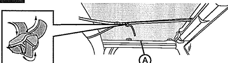
**Enlace la correa a través de la abrazadera que está sobre el parabrisas. Jale el extremo de la correa hacia atrás y hágalo pasar por la hebilla. Jale y tense firmemente.**
