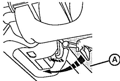
Attacher l'avant du capot pare-soleil au pare-brise.
