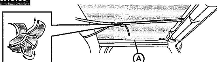
Passer la sangle par la boucle du pied de valet au-dessus du pare-brise. Tirer le bout de la sangle vers l'arrière et la passer par la boucle. La tirer fermement.
