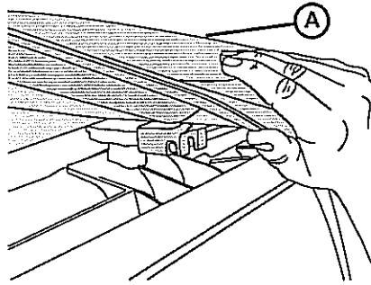
Installer le capot pare-soleil sur le véhicule. Accrocher l'adaptateur de carrosserie sur chaque côté par-dessus la traverse du cadre de portière.
