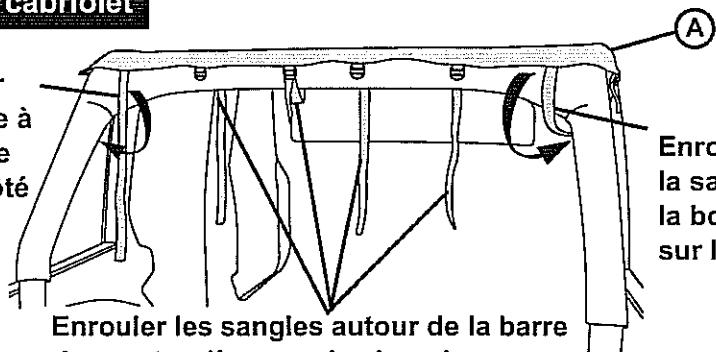
Enrouler la sangle à la boucle sur le côté
