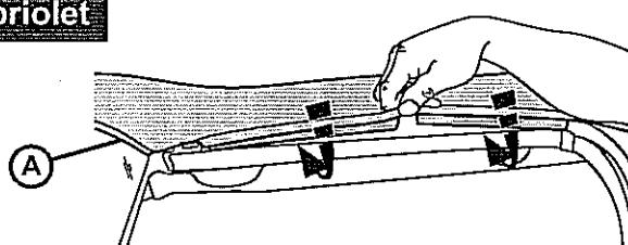
Rouler la bande de plastique au-dessus de chaque ouverture de portière dans le montant par-dessus la portière de chaque côté du véhicule.
