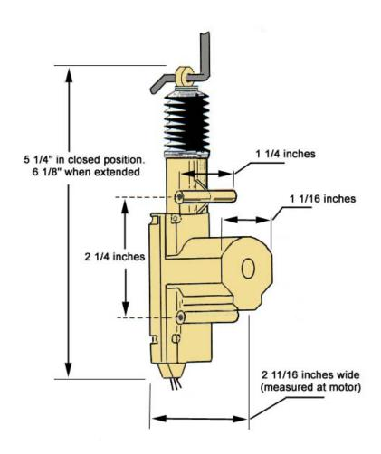
NOTE! WHEN INSTALLING A DOOR LOCK ACTUATOR, THE PLUNGER HEIGHT MUST BE ADJUSTED TO INSURE PROPER LOCK OPERATION. PISTON TRAVEL FROM A FULLY RETRACTED POSITION TO ITS FULLY EXTENDED POSITION IS 7/8". SET THE PLUNGER AT ONE HALF THE DISTANCE OF THE TOTAL TRAVEL (7/16"). THIS IS ABSOLUTELY CRITICAL TO PROPER OPERATION!!
