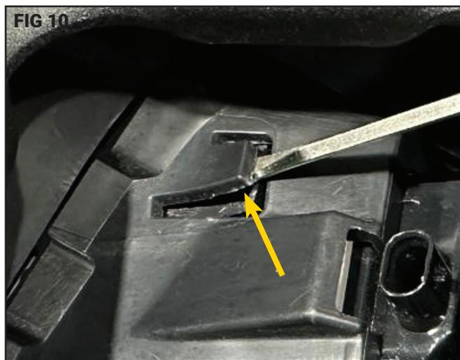
**STEP 6 - REMOVE BACKUP SENSORS AND HARNESS FROM THE FACTORY BUMPER:**
