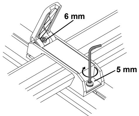
Il faudra peut-être régler à l'occasion la tension des bras pivotant. Utiliser une clé hexagonale de 5 mm.
