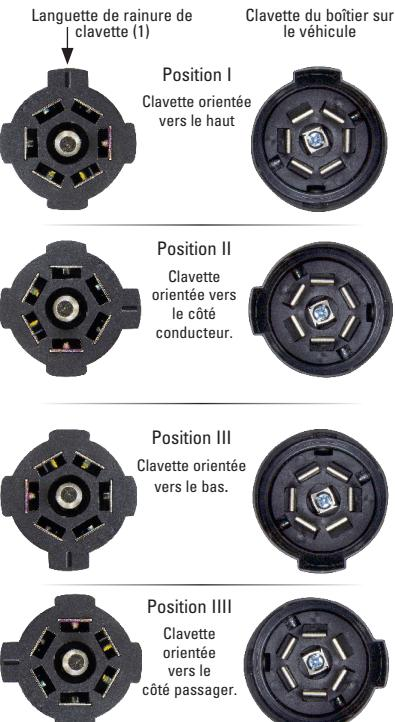
Une fois la clavette bien alignée, insérer l'ensemble dans le boîtier. Serrer les vis de pression.
