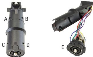
2. Faire passer le câblage de la remorque à travers le boîtier. Dénuder 6 mm (1/4 po) de chaque câble et les connecter aux bornes en respectant le schéma ci-dessous. **NE REPÉRER LES FILS QUE PAR LEUR FONCTION.** Prévoir un jeu de 46 cm (18 po) dans le câblage entre le véhicule et la remorque pour permettre les virages.
