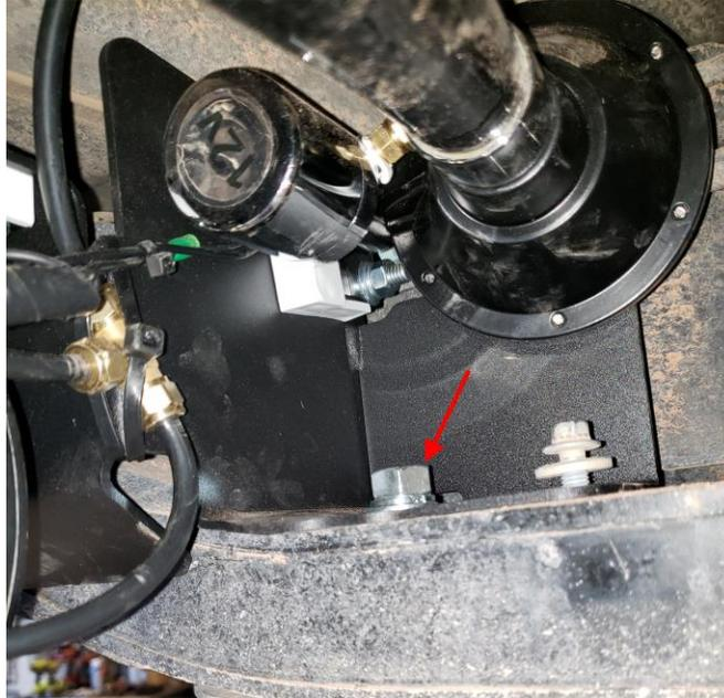
4. Secure bracket to crossmember using [H18](#), [H19](#), & [H20](#).
