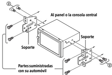
Al montar esta unidad en los soportes preinstalados de su automóvil, use los tornillos ② suministrados en los espacios para tornillos correspondientes según su automóvil:
