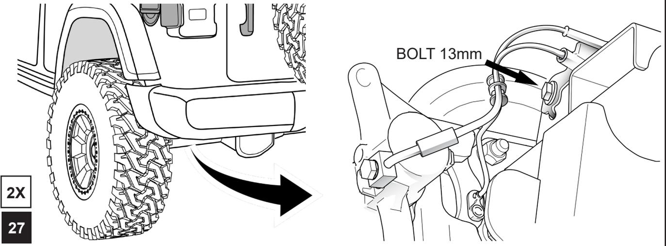
**REMOVE THE TRACK BAR FROM THE AXLE**
