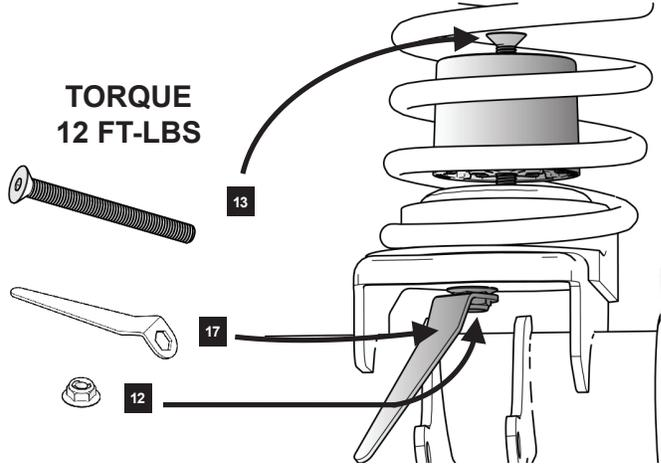
**FULLY SEAT THE SPRINGS INTO THE LOWER SPRING ISOLATOR**
