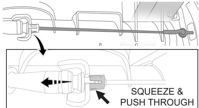
**ROUTE E-BRAKE CABLES UNDER CROSS MEMBER AND FUEL LINES.**
