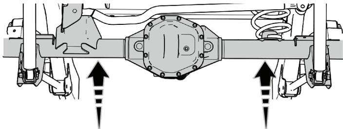
**MAKE SURE TO FULLY SEAT THE SPRINGS INTO THE UPPER SPRING ISOLATOR**
