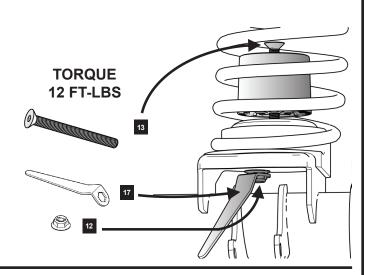
**FULLY SEAT THE SPRINGS INTO THE LOWER SPRING ISOLATOR**
