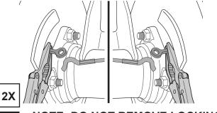
NOTE: DO NOT REMOVE LOCKING PLIERS FROM E-BRAKE EYELETS
