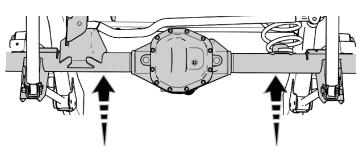
MAKE SURE TO FULLY SEAT THE SPRINGS INTO THE UPPER SPRING ISOLATOR
