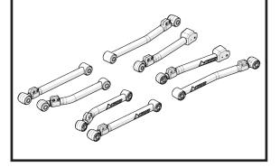
\*INSTALL CONTROL ARMS OR DROP BRACKETS WITH THE JEEP ON THE GROUND. THE WEIGHT OF THE JEEP WILL MAKE THE INSTALLATION EASIER\*
